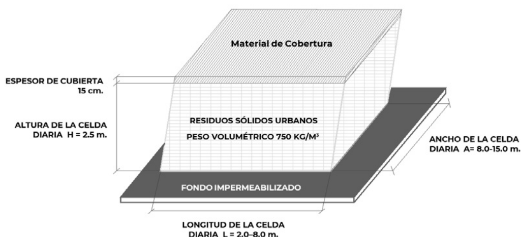
Ilustración 23 Esquema de celda para relleno sanitaria
